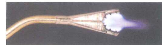
4555 BOQUILLA CERCOFLAM (210 g/h) / CERCOFLAM BURNER (210 g/h) WITH ENVELOPING FLAME - Recomendado para los trabajos de fontanería y ferretería. Soldadura del acero a alta temperatura. Esta boquilla está disponible con encendido PIEZO 4302. / Suitable for ironmongery and plumbing works. Steel welding at high temperature. This nozzle is available with piezo ignition PIEZO 4302.
