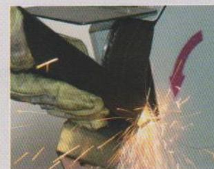
• Retirada rápida del material gracias a la gran velocidad de la banda de 33m/seg.
