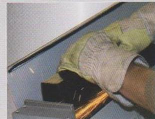
• El soporte de la superficie de lijado de extremo a extremo que está abierto en la parte de atrás también es muy apropiado para mecanizar piezas muy largas.
