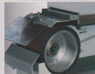
• Los rodillos de goma permiten un funcionamiento suave y evitan que la banda se desplace o se deslice.
