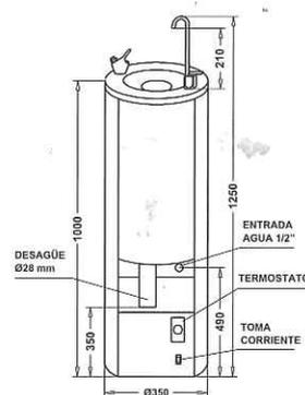
Instalación mediante tres puntos de conexión básicos.
