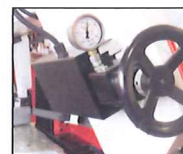
· Tensión de la cinta hidromecánica legible sobre manómetro.
