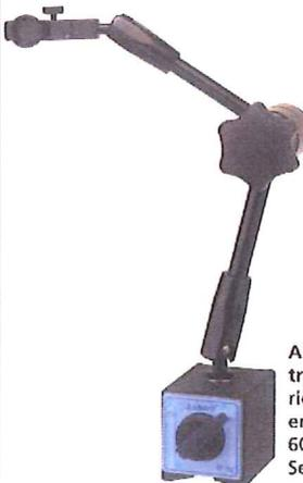
Altura máx. 280 mm. Bloqueo central con un tirador para junta inferior, media y superior. Chapa base en forma de V. Fuerza magnética 60 kg. Agujero de montaje Ø 8 mm. Se suministra en caja.
