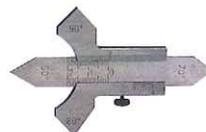
Para medición de juntas de soldadura planas y en esquina. Fabricada en acero. Graduada en mm y equipada con calibre vernier 1/10 mm. Puntos en ángulos 60°-70°-80°-90°. Se suministra en estuche de plástico. Escala de medición: 20 mm.
