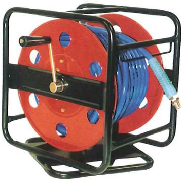
Con tubo flexible de poliuretano con tejido intermedio 30 m. Altamente flexible y resistente a la abrasión. Con articulaciones intermedias en el lado de entrada y en el de salida de aire, con lo cual se evita el retorcido de la manguera. Giratorio 360°. Rosca de conexión: 1/4". Diámetro interior: 8 mm. Presión efectiva máx.: 15 bares. Diámetro exterior: 12 mm
