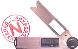
Con encaje en la parte superior. Pantalla que muestra números de gran tamaño. La pantalla puede mostrar 0 en cualquier posición y cambiar a valor absoluto. Botón de función de espera. Los brazos se inmovilizan con el tornillo de fijación y adoptan múltiples y diferentes posiciones.
