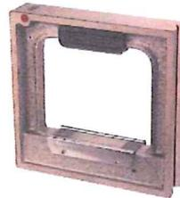
De burbuja. De marco. Longitud 100 mm. Fabricado en acero fundido. Gran precisión. Juego de superficies en forma de V. Clinómetro regulable. Precisión según DIN 877.
