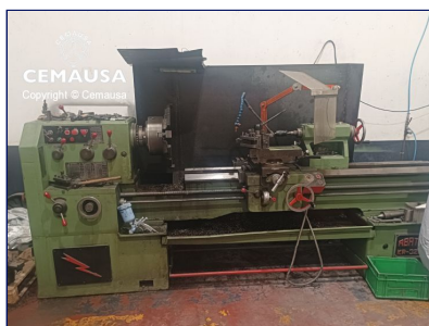
Torno cilíndrico 2000x320 m/m.
