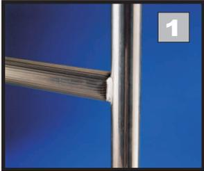
1-El peldaño con diámetro 35 mm se fija al montante mediante una soldadura certificada. Es un peldaño estriado y antideslizante en toda la superficie para un agarre más fuerte con manos y pies. El peldaño está reforzado con un espesor de 1.75 mm para una mayor resistencia.
