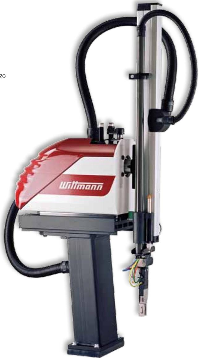
Servoextractor **WS80** para la extracción y separación de coladas ahorrando espacio.
