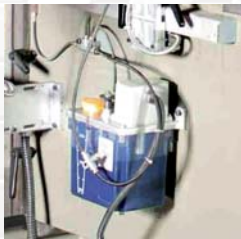
ENGRASE CENTRALIZADO AUTOMÁTICO SYSTÈME DE LUBRIFICATION AUTOMATIQUE AUTOMATIC LUBRICATION SYSTEM AUTOMATISCHE ZENTRALISIERTE SCHMIERUNG
