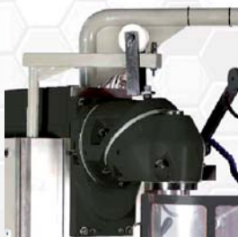
CABEZAL UNIVERSAL ISO40 CON SOPORTE DE ACOPLAMIENTO TÊTE UNIVERSELLE ISO40 AVEC SUPPORT D'ACCOUPEMENT ISO40 UNIVERSAL HEAD WITH DOCKING HEAD UNIVERSALSPINDELKOPF MIT HALTERUNG
