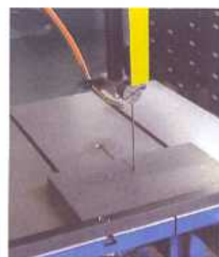
Mesa con desplazamiento neumático Table with pneumatic automatic movement
