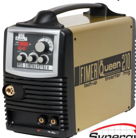
Soldadoras **inverter**, monofásicas, ventiladas, con control de microprocesador para la soldadura **hilo MIG-MAG, TIG y electrodos MMA**. Especialmente indicadas para la soldadura de **aluminio, hierro, acero inoxidable y de elevada resistencia, láminas galvanizadas, etc.** Con bobina interna hasta 5 kg, y externa de 15 kg mediante accesorio opcional.
